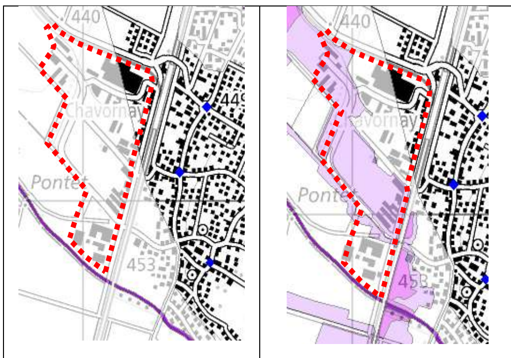
Figure 9 : Intensités pour T jusqu'à 100 ans (image de gauche) ; T jusqu'à 300 ans (image de droite)
